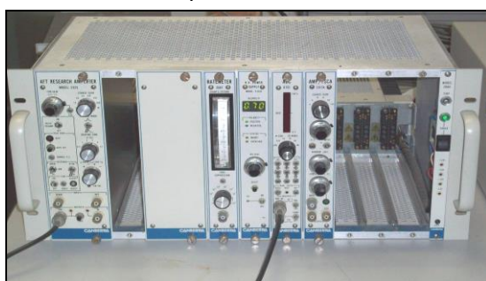
ภาพที่ 3.2 ข. เครื่องขยายสัญญาณ (amplifier) และ เครื่องจ่ายไฟแรงสูง (high voltage power supply)
