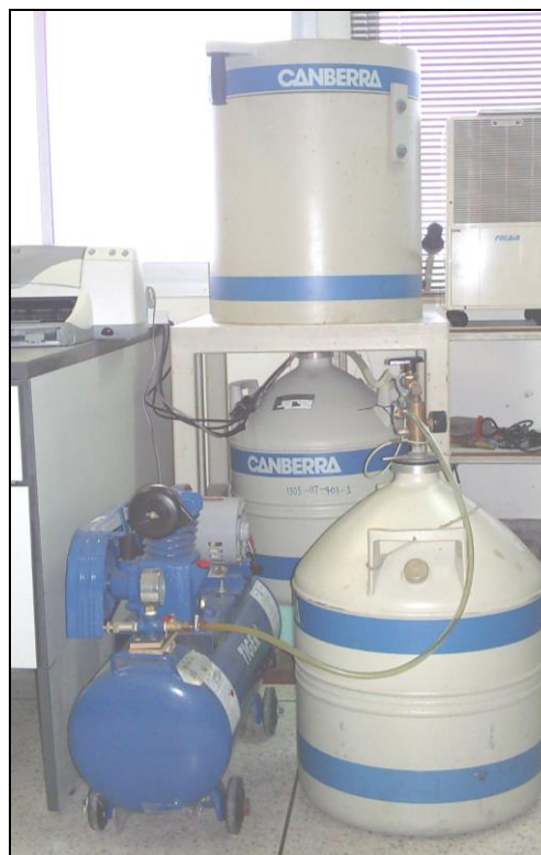
ภาพที่ 3.2 ค. เครื่องสเปกโตรมิเตอร์ รังสีแกมมา ชนิดหัววัดแบบ HPGe
