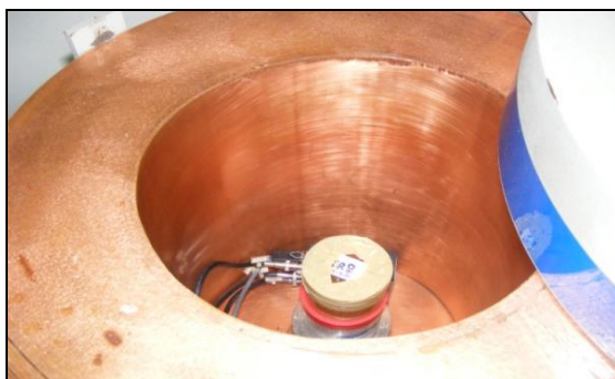
ภาพที่ 3.2 ก. หัววัดรังสีแบบเจอร์มาเนียมบริสุทธิ์ รุ่น GC 2018
